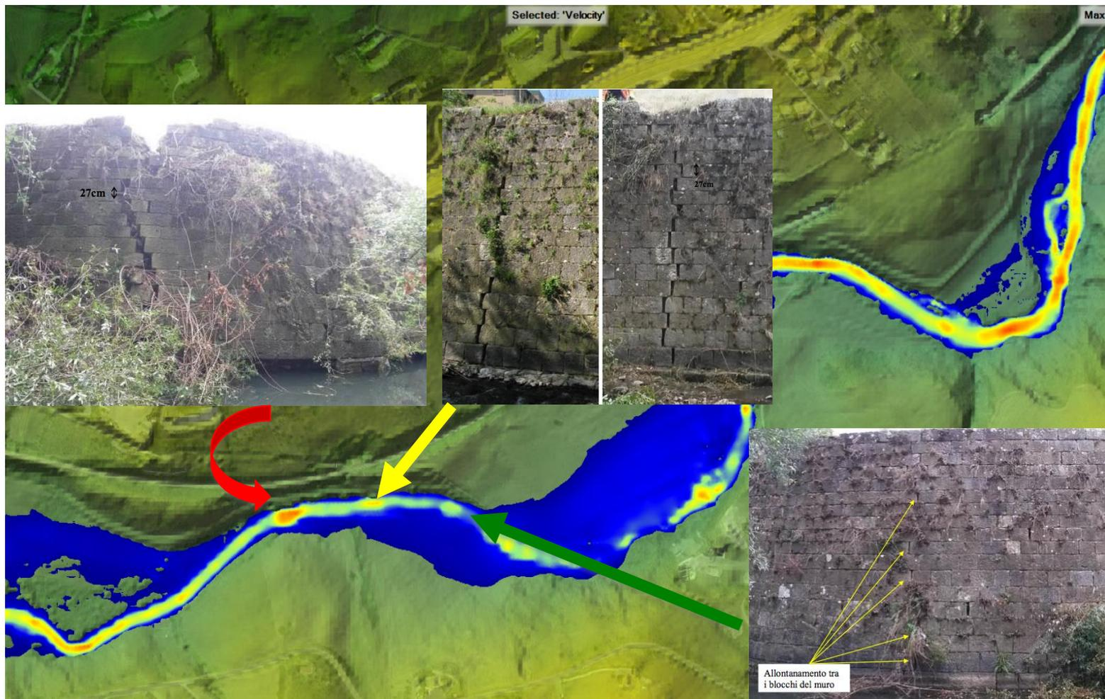
Allo stato attuale le modellazioni numeriche bidimensionali evidenzerebbero campi cinematici caratterizzati da elevati valori delle velocità locali con conseguenti elevati sforzi tangenziali lungo le sponde e il fondo alveo
